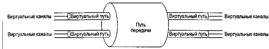
Рис 3.9. Взаимосвязь между виртуальными каналами, виртуальными путями и путями передачи в ATM-сети
